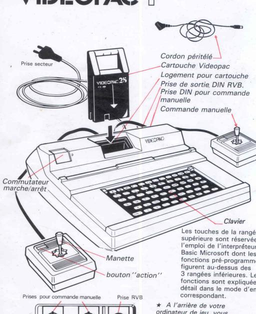
\* A l'arrière de votre ordinateur de jeu, vous trouverez deux prises DIN (6 broches) pour les commandes manuelles et une prise DIN (8 broches) servant de connecteur de sortie RVB.
